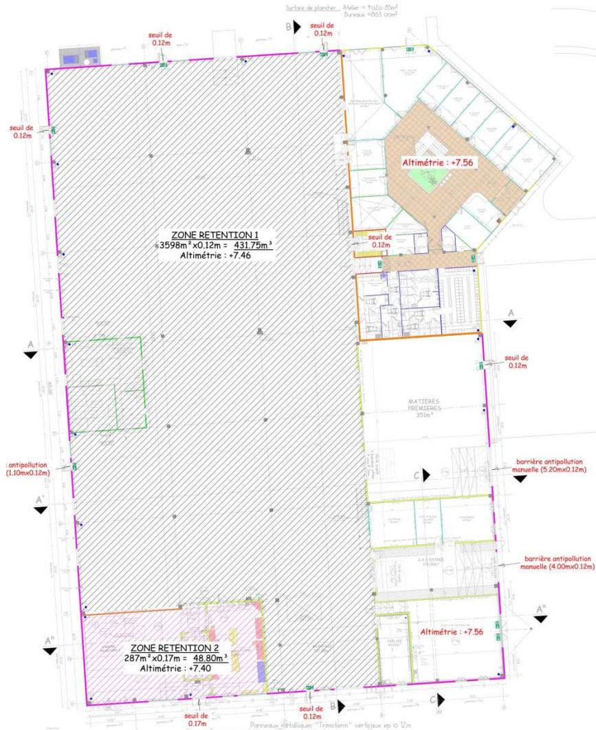
Figure 37 : Rétention interne du bâtiment
